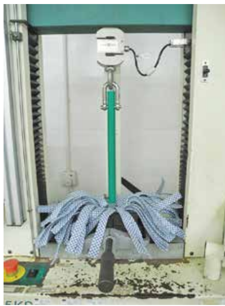
圖四：拖頭棉線或纖維布料的接合強度
