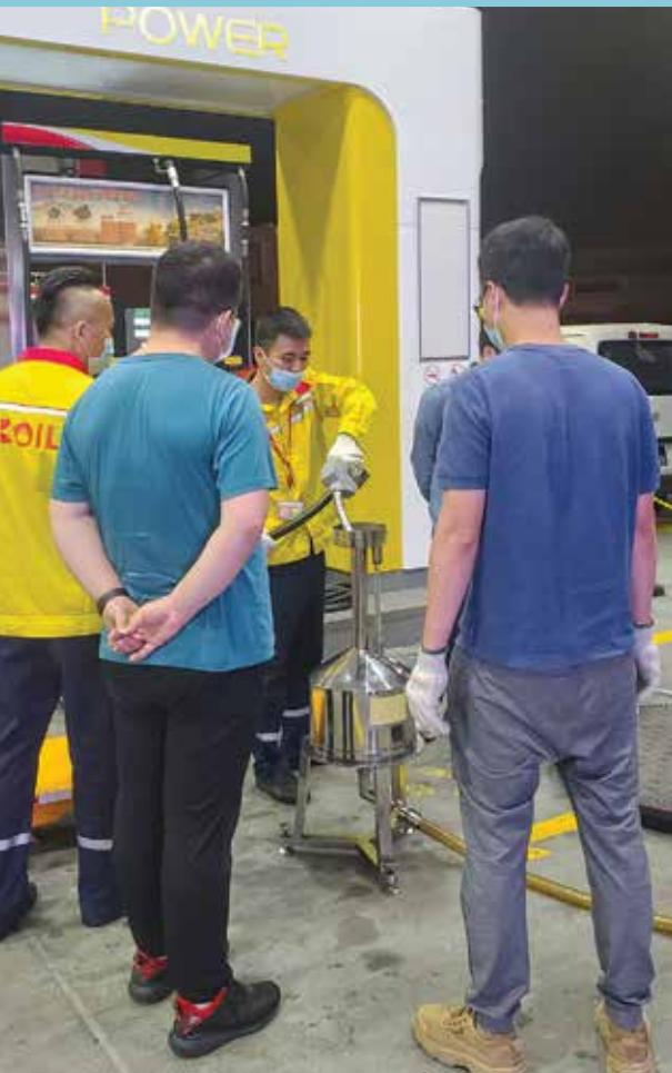
檢定工作對全澳20個加油站都會進行抽查，每個加油站由該站負責人以隨機抽樣方式選取1個油錶樣本，根據中國國家計量檢定規程JJG443-2015《燃油加油機》作為參考標準進行檢定，而且檢定工作會於同一日內完成，以確保結果的公平性。
