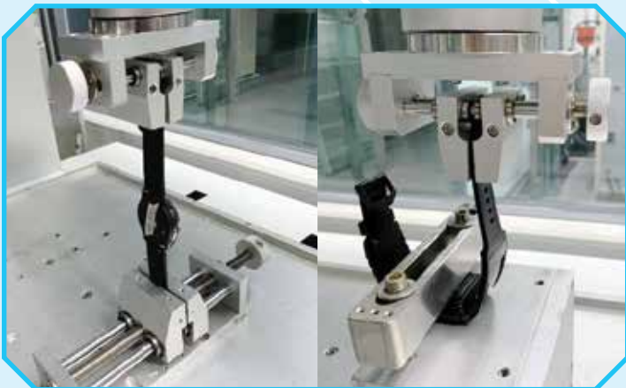
Imagem 1 Imagem sobre o processo de realização de ensaios de tracção
